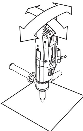
Si l'arrière de la machine est orienté vers le bas, le LED central vert s'éteint et le LED avant rouge s'allume. Si l'extrémité arrière de la machine est orientée vers le haut, le LED rouge arrière s'allume.
