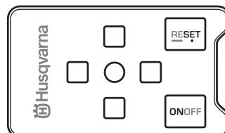
El LED verde situado en la parte central se enciende mientras que la máquina está en la posición correcta.
