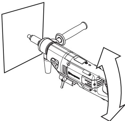
Si l'arrière de la machine est orienté vers le bas, le LED central vert s'éteint et le LED avant rouge s'allume. Si l'extrémité arrière de la machine est orientée vers le haut, le LED rouge arrière s'allume.
