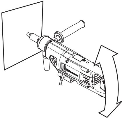
Si la parte posterior de la máquina se inclina hacia abajo, el LED verde de la parte central se apaga y el LED rojo de la parte delantera se enciende. Si el extremo posterior de la máquina se inclina hacia arriba, el LED rojo de la parte trasera se enciende.
