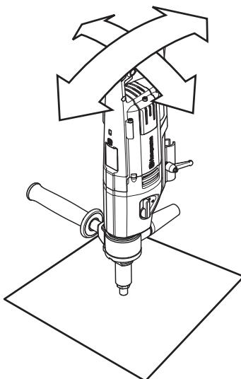
Si la parte posterior de la máquina se inclina hacia abajo, el LED verde de la parte central se apaga y el LED rojo de la parte delantera se enciende. Si el extremo posterior de la máquina se inclina hacia arriba, el LED rojo de la parte trasera se enciende.
